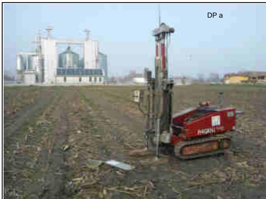
**Foto 3** – Fase di esecuzione della prova penetrometrica DPH3
